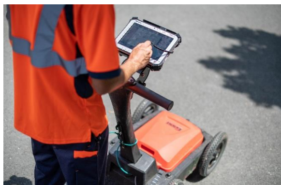
Figure 2 : Géoradar GSSI DF 300-800
